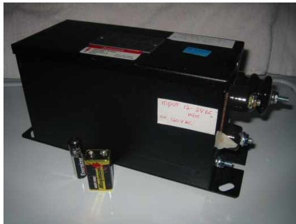
15,000 volt Neon sign transformer
